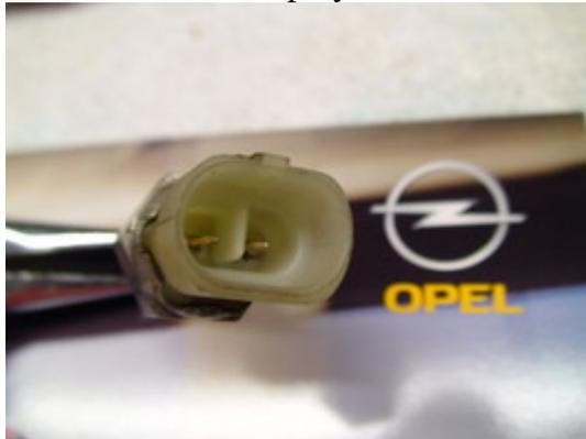
Hilft dies immer noch nicht, kann es am Schalter selbst liegen. Er muß raus. Mit Hilfe eines Maulschlüssel SW 19, siehe Foto. Keine Angst, es kommt kein Öl raus!
