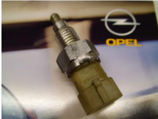
Nun den Stecker selbst prüfen, ist er fest dran? Ist er verdreht oder gar oxidiert? Stecker reinigen und mit Kontaktspray behandeln. Siehe Foto.
