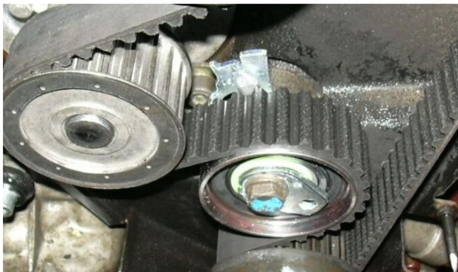
Befestigungsschraube-Spannrolle lösen. Zahnriemen abnehmen.
