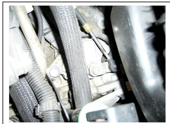
Nun die Mutter an der Welle [D] lösen und das Gestänge nach oben abziehen.
