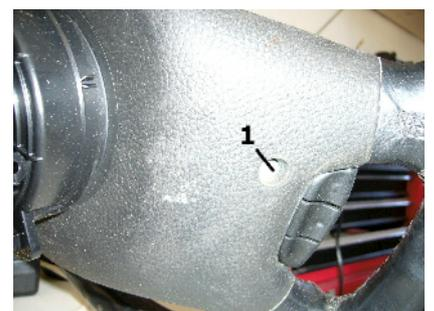
Leicht gesagt! bei mir saß das Lenkrad sehr fest. Ich habe die Mutter ca. 2 Umdrehungen gelöst und eine 21er Nuß drauf gesetzt. Dann hat ein Helfer auf dem Fahrersitz Platz genommen und das Lenkrad mit den Knien nach oben gedrückt, so dass ich nun mit einem Hammer (einem richtigen Hammer) die Säule nach unten schlagen konnte. Nicht die sanfte Methode, hat aber funktioniert.
